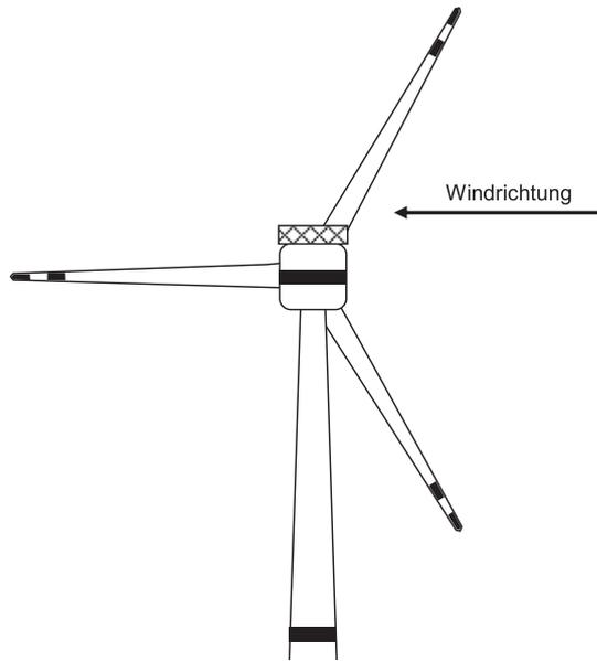
Abbildung 2b: Beispiel für ein Rotorblatt in aufgerichteter Position in Windrichtung für Hubschrauber mit linksseitiger Winde
