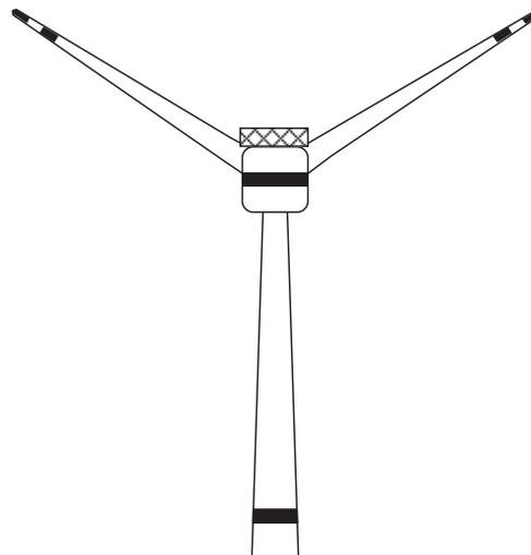
Abbildung 2c: Beispiel für einen Rotor in Y-Position
