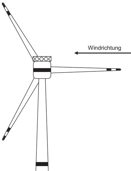
Abbildung 2a: Beispiel für ein Rotorblatt in horizontaler Position in Windrichtung für Hubschrauber mit linksseitiger Winde
